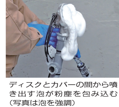
発生した泡を吸引し、液だれを抑制しながら作業ができる
