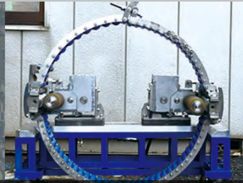
**製** 管機をマンホール内に固定し、更生管を既設管内に押し出していくため、「元押式」といいます。
