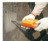
非破壊方式による圧縮強度の推定
