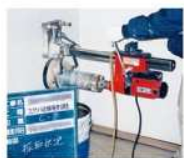
コンクリート試料の採取
