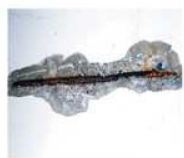
目視調査(鉄筋腐食度調査)
