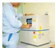
コンクリート試料のX線解析
