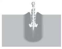
周囲の土は、圧密により押し固められ支持力を向上。空気を送りながらドリルを引き抜きパイル状の空洞が完成。
