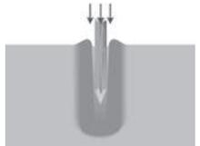
排土せず杭体積だけ圧密するので、原地盤支持力が向上する。
