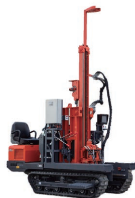
写真 1. スーパーナロー専用施工機
