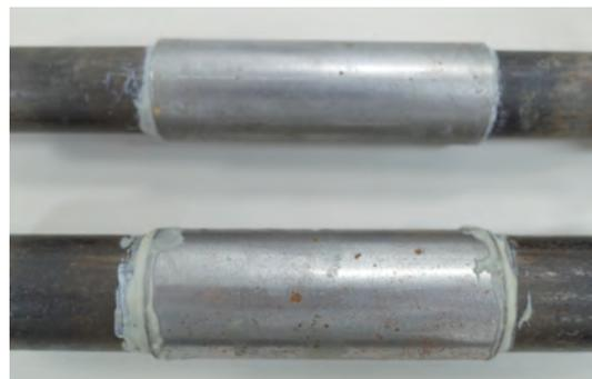
写真8. ジョイント金具接着状況
