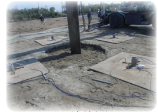
液状化振動実験中
